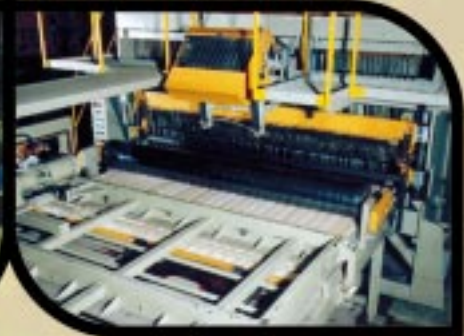
Ligne complète de production automatisée pour la fabrication et l'assemblage de panneaux de clôture
