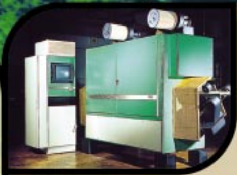
Optimiseur de classification multisenseur pour la détection de défauts dans le bois franc
