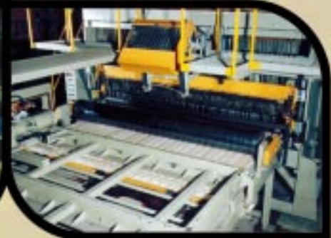
Ligne complète de production automatisée pour la fabrication et l'assemblage de panneaux de clôture
